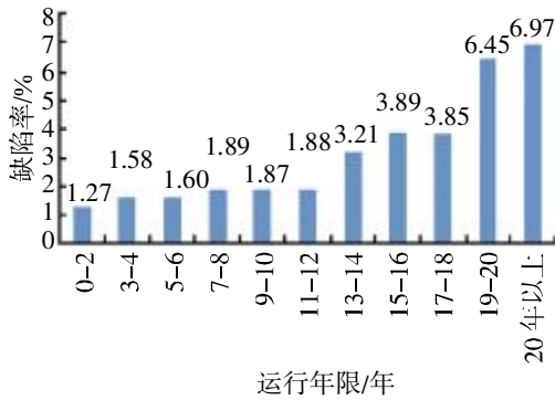
图3 不同运行年限 GIS 控制系统缺陷率
